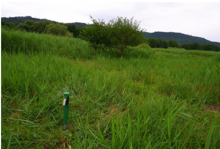
Obr. 8: Sonda na měření hladiny podzemní vody v revit. části mokřadů v I. 2023-25.
