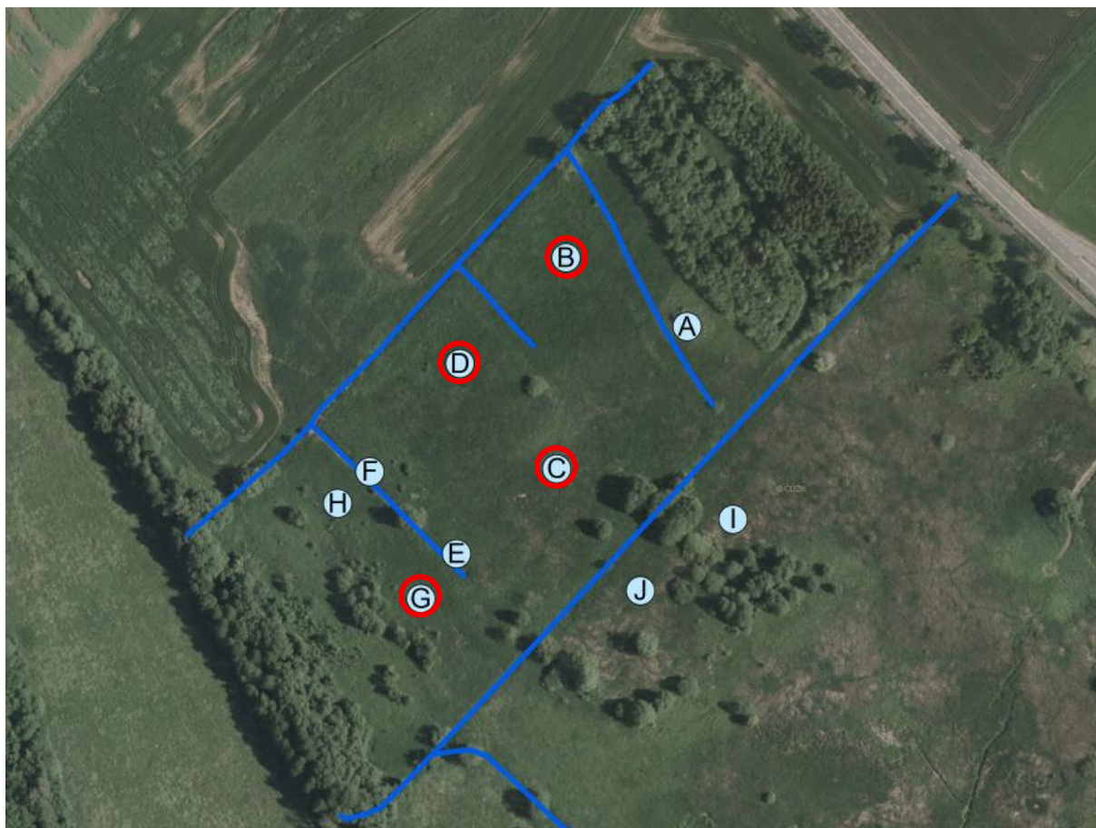
Obr. 9: Rozmístění sond v rámci západní části mokřadů v roce 2014 a výběr sond pro měření hladinoměry v letech 2023–25 (označeno červeně).
