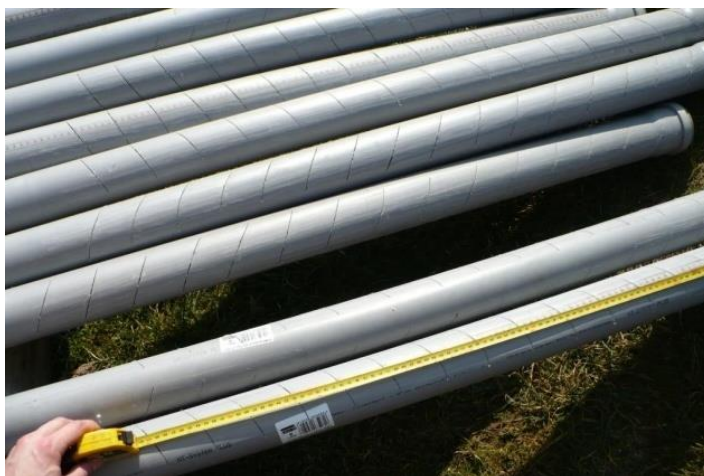
Obr. 7a, 7b: Sonda na měření PV v mokřadu v roce 2014 a perforace PVC trubek.
