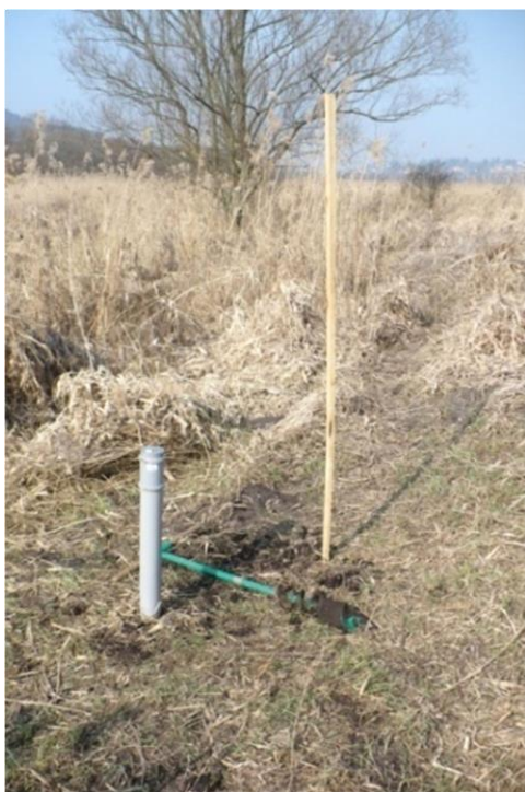
Obr. 7a, 7b: Sonda na měření PV v mokřadu v roce 2014 a perforace PVC trubek.
